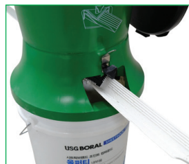
② 호퍼통의 노즐을 조절한 후 재단하신 코너비드를 통과 시키면 코너비드 안쪽에만 퍼티가 일정하게 도포됩니다.
